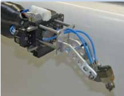
Bild 3: An das automatische Schnellwechselsystem angedockter pneumatischer Zerstäuber
