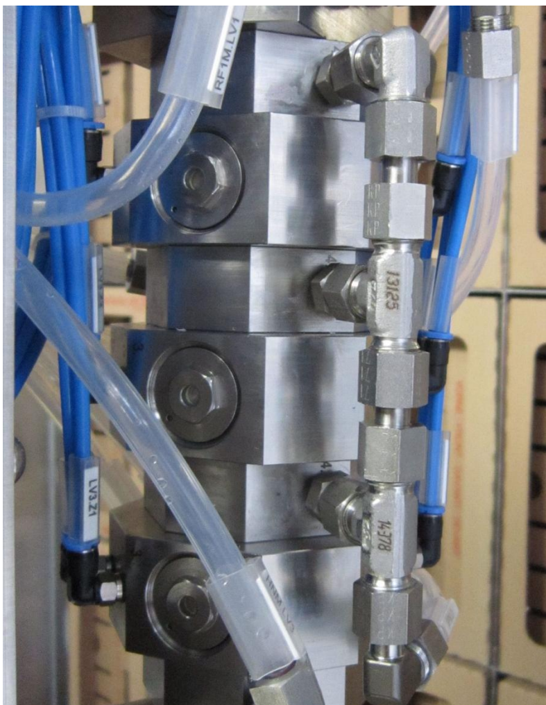
Abbildung 3: 2K-Linienfarbwechsler am LabPainter
