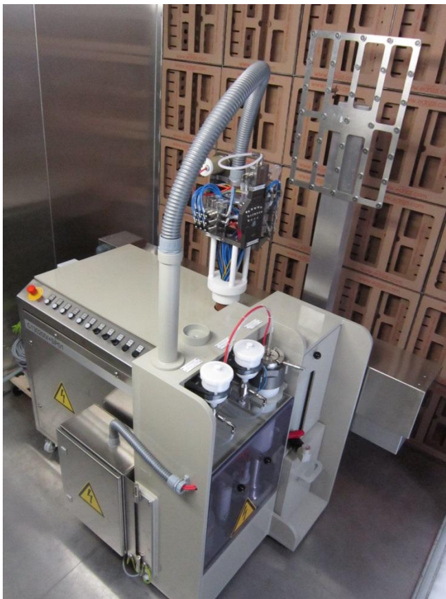
Abbildung 1: Linearachsen des LabPainters
