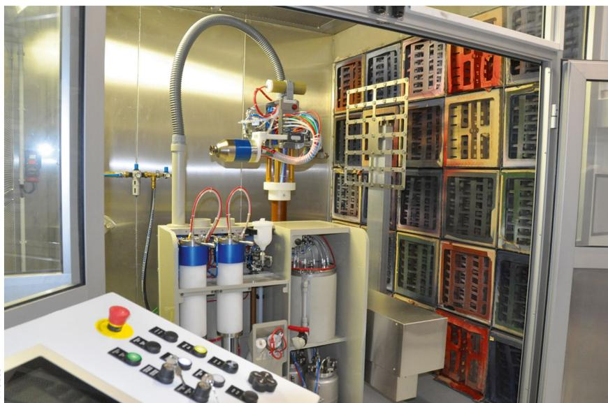
Die Laborlackieranlage BAS.Painter in einer Lackierkabine mit einem Rotationszerstäuber in der Service-Position.
